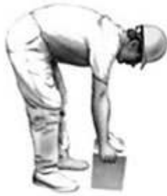
Manera incorrecta de levantar
